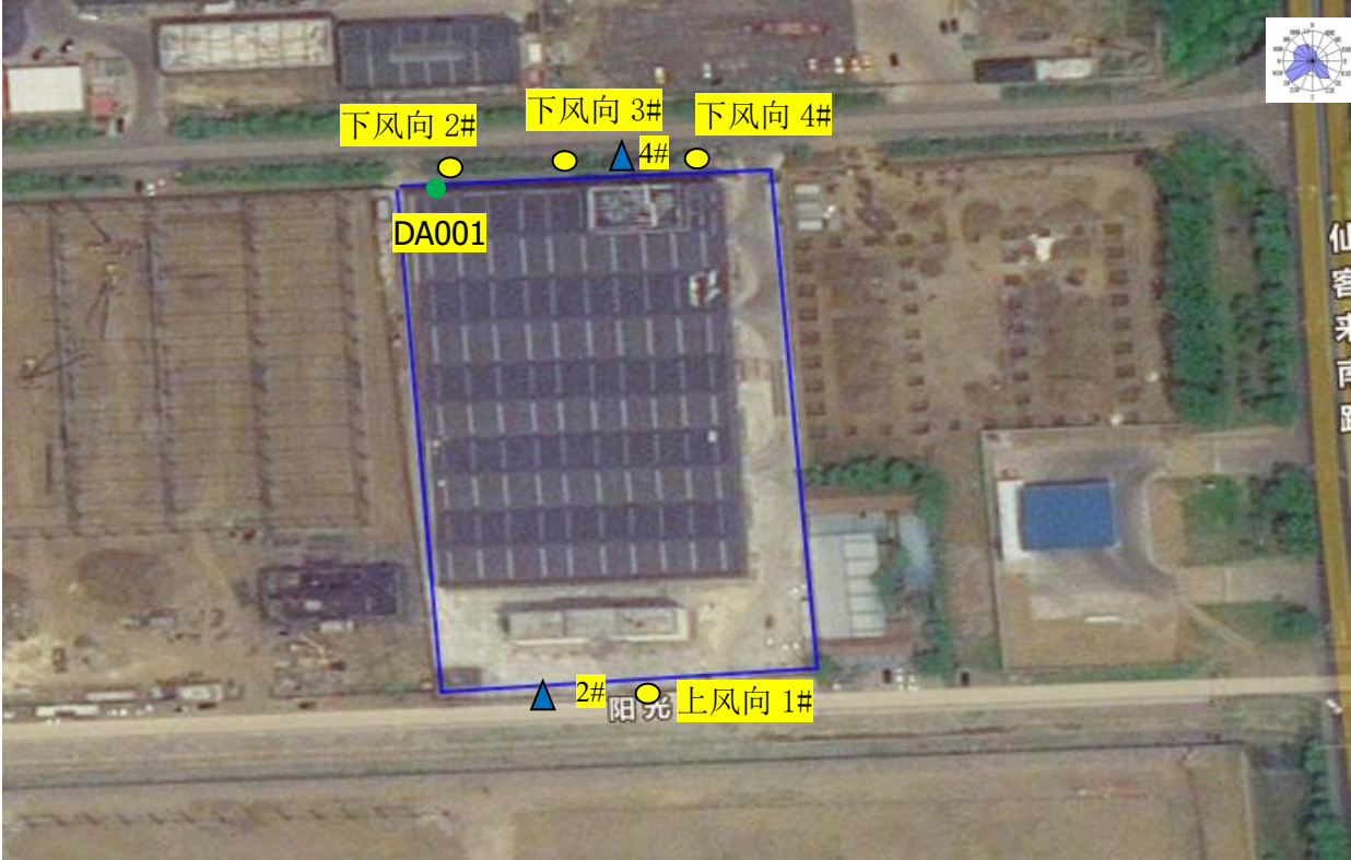
图 6-1 废气和噪声监测点位布局图
