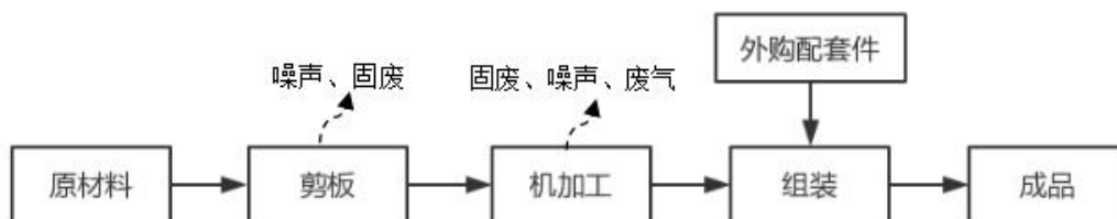
风机生产工艺流程及产污环节示意图
